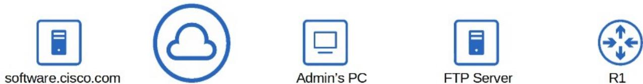
Le serveur Cisco, récupère l'image IOS depuis Cisco, puis il place l'image IOS sur un serveur joignable par l'appareil pour être mis à jour, sur le réseau se sera le serveur FTP. Puis le routeur R1 utilise FTP/TFTP pour copier le fichier dans la mémoire flash de l'appareil.
